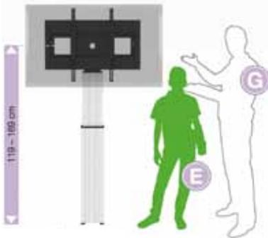
Soporte fijo con ajuste de altura motorizado
